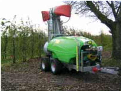
A 2000 literes modell tandemtengellyel és nyomkövető vonórúddal kisebb fordulókörhöz.
