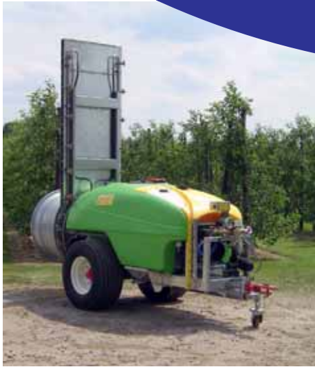
Az 1500 Literes gép 3,05 méter magas keresztáramú permetezőkonzollal A permetezési magasság sortávolságtól függően maximum 4 méter. Minden keresztáram permetezőkonzollal rendelkező modell nemesacélból készült.
