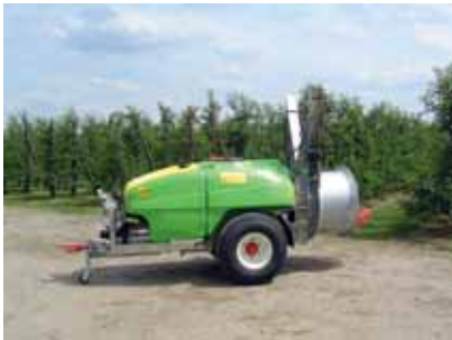
Az 1000 literes modell és az állítható ECO-keresztáramú permetezőkonzollal (2,15 méter magas). Ez az egyszerűen átállítható keresztáram permetezőkonzol 2,10 és 6 méter magasság közötti kultúrákban használható.
