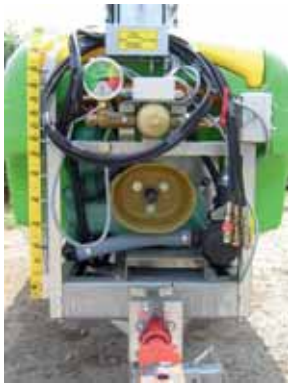
Nagy manométer, elektromos szelepek és nyomásszabályozó, jól elérhető szívó- és nyomószűrő. Töltési szint kijelző elől és oldalt a tartályon.
