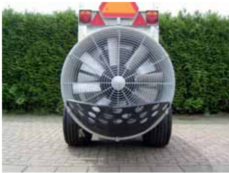
A ventilátor (80 cm) 8 lapáttal és üresjárattal. A ventilátor lapátok szöge manuálisan állíthatók.
