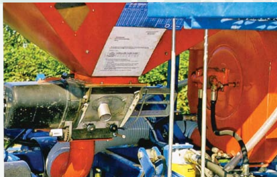
Az adagolóegység és a hidraulikusan hajtott ventilátor a Rauchtól származik
