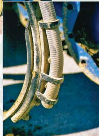
A vetősorok visszatömörítésének feladatát a rugóterheléses STS tömörítő henger veszi át
