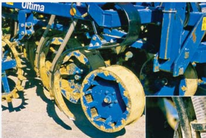
A vetősorok visszatömörítésének feladatát a rugóterheléses STS tömörítő henger veszi át
