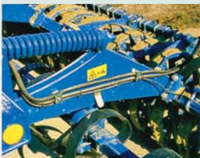
A vetősorok visszatömörítésének feladatát a rugóterheléses STS tömörítő henger veszi át
