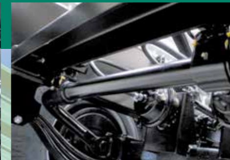
Rugó stabilizátor az optimális futásjellemzőkhöz
