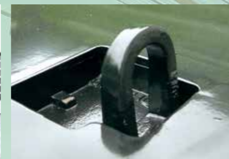
Rögzítő karikák lt. EN 12640 besüllyesztve a platófenékbe
