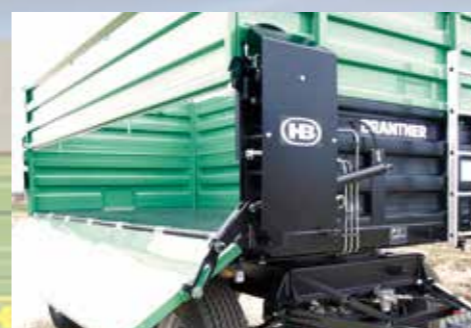
Hidraulikus oldalfal nyitás oldalra 180°, nyitás és zárás
