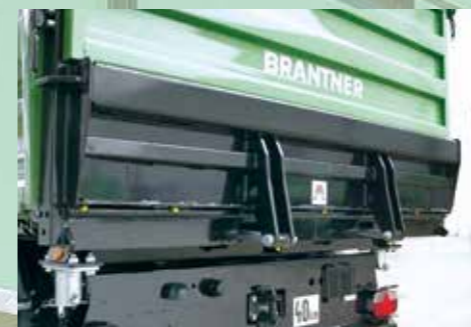
Hidraulikus hátsó fal nyitás 120° préselt profilból
