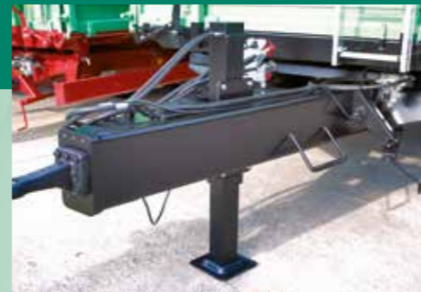
Hidraulikus támasztóláb kettősműködésű, cső-a-csőben vezetés
