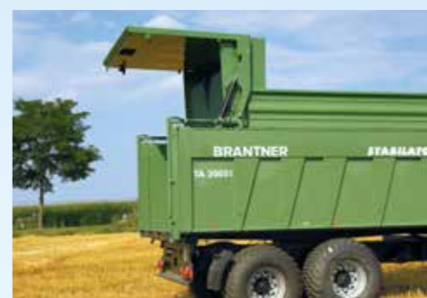
Hidraulikus hátsó fal nyitás kettős működésű
