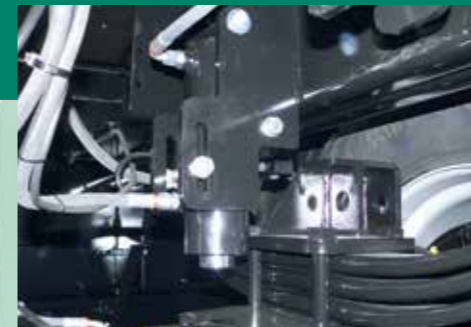
Hidraulikus hátsótengely támasztás hidraulikus hátsó fal nyitással kombinálva
