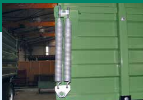
Oldalfal emelőrugók két-két darab bal és jobb oldalt (csak 800 mm-es oldalfalnál lehetséges)
