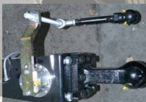
Elektronikus kényszerkormányzás nem szükséges reteszolni hátrafelé tolásnál és közúti közlekedésnél
