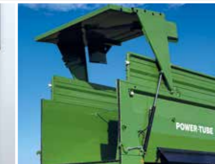
Hidraulikus kettősműködésű hátsóoldal nyitás
