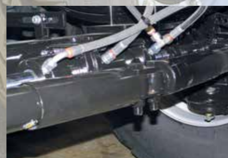
Utánfutó kormánytengely reteszolni kell hátrálásnál és közúti közlekedésnél
